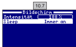
10.7 Einstellung der Bildschirmhelligkeit (0-100 %) und Programmierung Bildschirm Ein/Aus.
