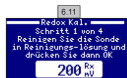
6.11 Beispiel des ersten Schritts einer Kalibrierung mit Pufferlösung. Führen Sie die 4 Schritte aus.
