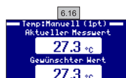
6.16 Korrigieren Sie mit den Tasten MEHR/WENIGER den von der Sonde angezeigten Messerwert, bis er mit dem Referenzwert übereinstimmt. Anschließend OK drücken.
