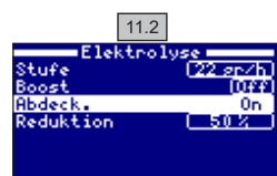
11.2 Prozentuale Reduzierung der Chlorproduktion bei geschlossener Pool-Abdeckung. Wenn die Abdeckung geschlossen ist, muss das System nicht mit 100 % betrieben werden. Dieser Parameter erlaubt eine optimale Einstellung der Chlorproduktion.
