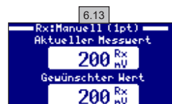
6.13 Ohne die Sonde aus dem Wasser zu nehmen, korrigieren Sie mit den Tasten MEHR/WENIGER den angezeigten Messerwert, bis er mit dem Referenzwert übereinstimmt (Fotometer oder anderes Messgerät).
