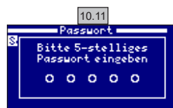
10.11 Passwort: Zugangsbeschränkung zum Benutzermenü durch Vergabe eines Passworts. Zur Eingabe Ihres Passworts wählen Sie eine Kombination aus 5 Tasten. Diese Kombination wird im System gespeichert. Wenn Sie Ihr Passwort vergessen, gibt es ein „Master-Passwort“. Kontaktieren Sie Ihren Hersteller/Händler.
