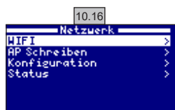
10.16 WLAN: Wählen Sie "WIFI", um die verfügbaren Netze am Modul anzuzeigen. Die Suche läuft automatisch ab.
